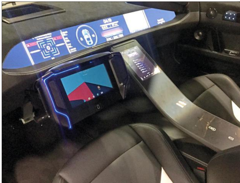
Funktionen per Touch: das Innere des Corning-Showcars mit gebogenem Glas in der Mittelkonsole und Display über die gesamte Cockpit-Länge.
