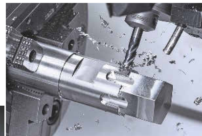
Bearbeiten der Titan-Hinterachse der dritten Version des Tübinger Pedal Cars.
