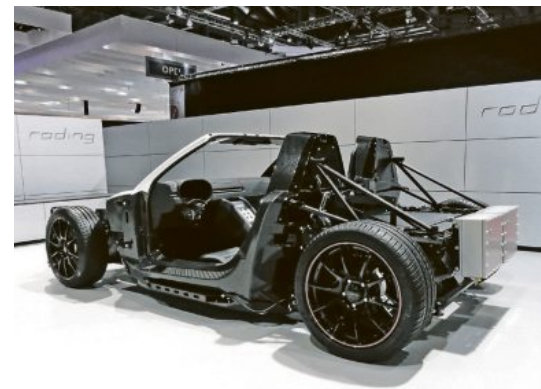
Die Carbon-Fahrzeugstruktur in der Konfiguration mit batterieelektrischem Antrieb für den Kunden Siemens.
