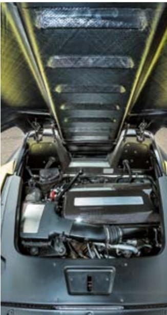
**Der komplette Antriebsstrang stammt von BMW und blieb unangetastet. Die 320 Turbo-PS haben mit den 1106 Kilogramm sehr leichtes Spiel**
