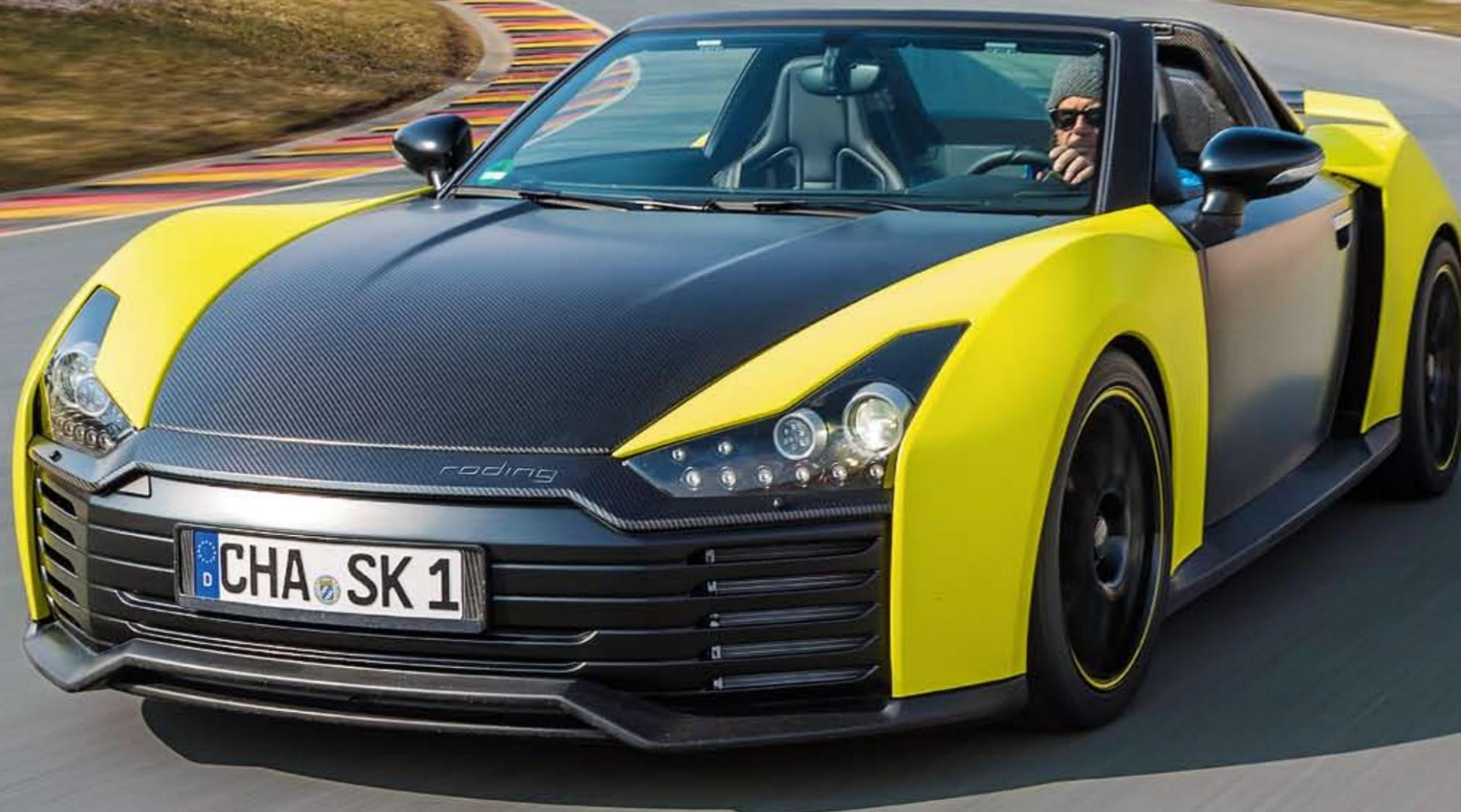
Nein, das ist keine Folie, sondern das für den Bau des 1106-Kilo-Leichtgewichts aus dem bayerischen Roding eingesetzte Echtcarbon
