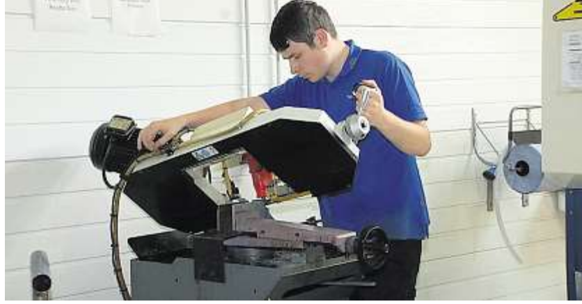
Mit der Bandsäge wird ein Metallklotz millimetergenau geschnitten.
