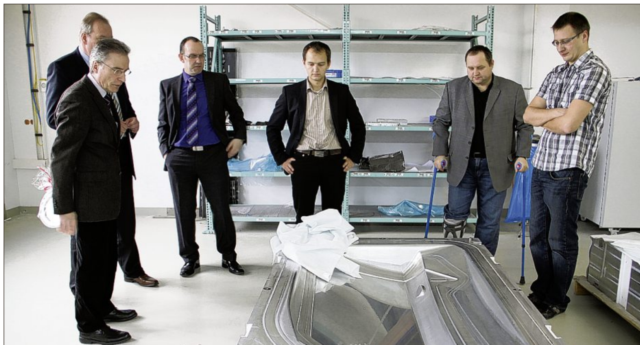
In dieser Form wird die Tür des „Roding Roadster“ gefertigt.
