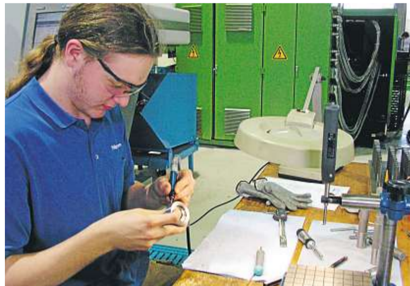
Philipp Werner beim Entgraten und Messen einer Fräskante
