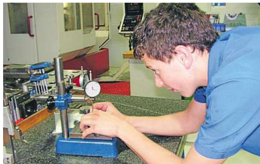
Thomas Dirscherl beim Messen einer Führungsleiste auf Stativ
