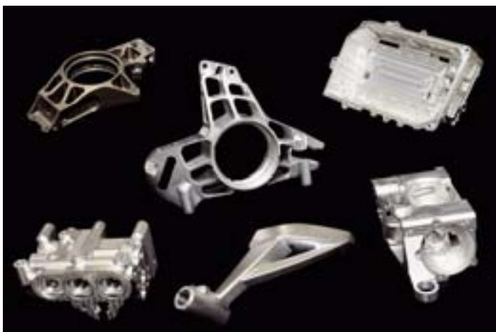
Auszug des bei Stangl + Co. bearbeiteten Teilespektrums: u. a. der Prototyp eines Radträgers aus Aluminium, der später in Titan zu fertigen ist. Der Prototyp wurde aus dem Vollen (Blockgewicht 27 kg) gefräst und wiegt als Fertigteil 2300 g
