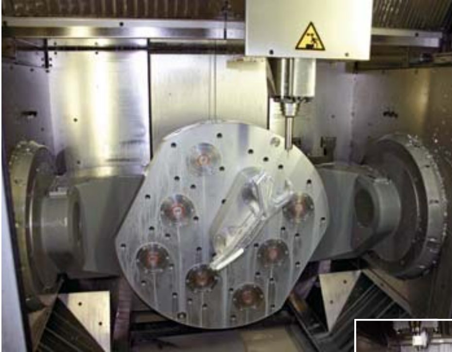
Arbeitsraum des 5-Achsen-Hochleistungs-Bearbeitungszentrums C 40 U mit Schwenkrundtisch Durchmesser 800 mm und multifunktionalem Basis-Spannsystem
