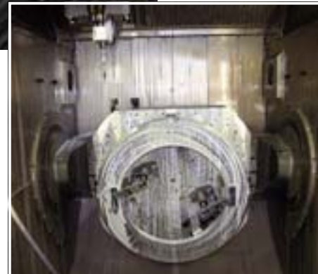
Arbeitsraum der neuesten Errungenschaft: Ein 5-Achsen-Hochleistungs-Bearbeitungszentrum C 50 U mit NC-Schwenkrundtisch Durchmesser 1150 mm zur 5-Achsen-Simultan-/Komplettbearbeitung größerer Werkstücke
